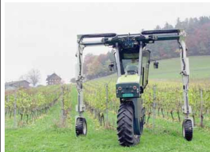
Ce prototype de tracteur peut être utilisé sur les sols inclinés grâce à ses deux «béquilles», qui s'adaptent en longueur et en largeur. SP-OHARD
